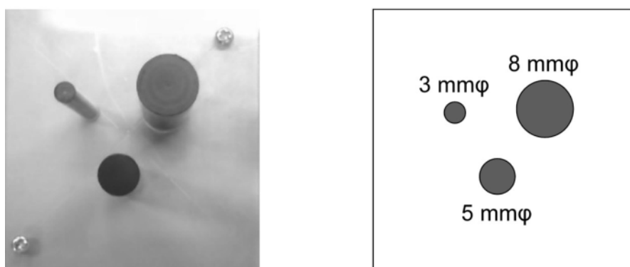
Fig. 3 PMMA 撮像ファントム (左：実画像, 右：ファントム概観図)
